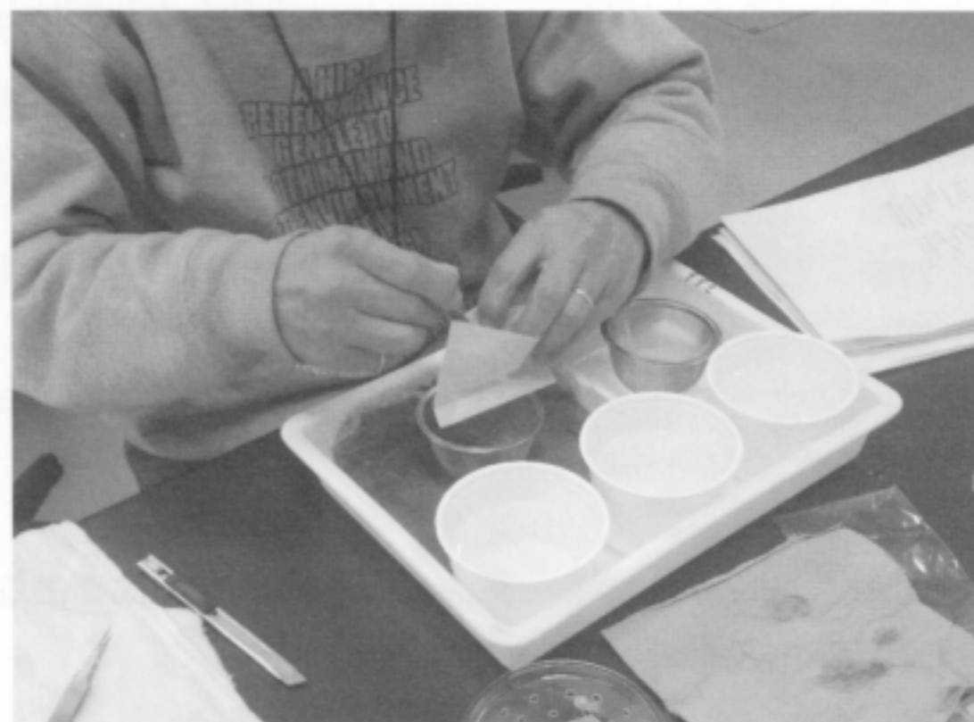
図4：茶こしに標本を入れ、カップに入れた殺菌・洗浄液からすすぎ液へ順に移しながら、筆を使って慎重に処理をした。洗い終わった標本をお茶パックに入れているところ。
